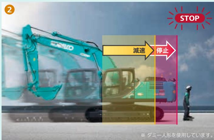
1 センサが人や障害物を検知すると、キャブ内のマルチディスプレイに検知エリアを表示。黄色が減速エリア、赤色は停止エリア内での検知を示します。停止エリアで検知した際はアラームと警告表示でもお知らせします。
