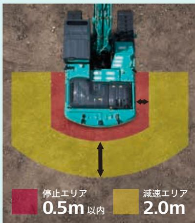
安全性と作業性を両立した検知エリア設定。
