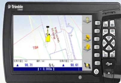
ディスプレイの作業指示で3次元の複雑な施工面も丁張りなしで高精度な仕上げが可能になります。
