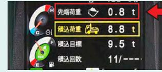
先端荷重がそのまま積み込むと積込目標をオーバーする場合にはブザーと赤枠で警告します。
