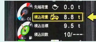
積込目標に対して先端荷重が1.5ton未満になるとブザーと黄色枠表示で警告します。
